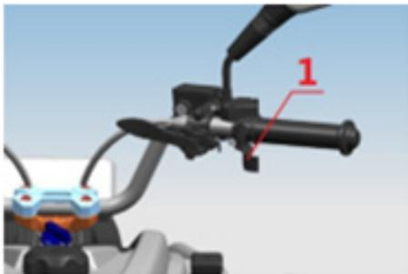
El acelerador (1) controla el régimen del motor. Para aumentar la velocidad del motor, utilice el pulgar para pisar el acelerador. Para reducir la velocidad del motor, suelte el acelerador retirando el pulgar, y el motor volverá al ralentí.
