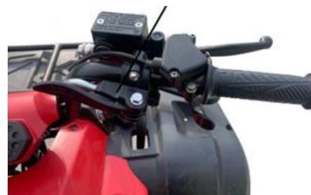
Para accionar el freno de estacionamiento, mueva la palanca de freno hacia la derecha mientras presiona la palanca del freno delantero. Suelte la palanca y compruebe que el freno de estacionamiento está accionado. Para soltar el freno de estacionamiento, mueva la palanca hacia la izquierda
