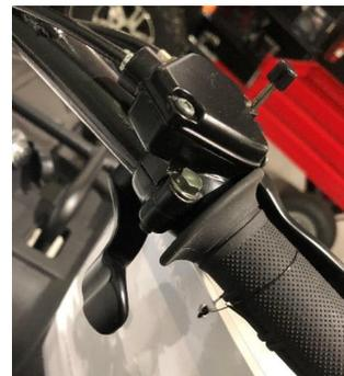
El acelerador controla el régimen del motor. Para aumentar el régimen del motor, pise el acelerador con el pulgar. Para reducir la velocidad del motor, suelte el acelerador retirando el pulgar y el motor volverá al ralentí.
